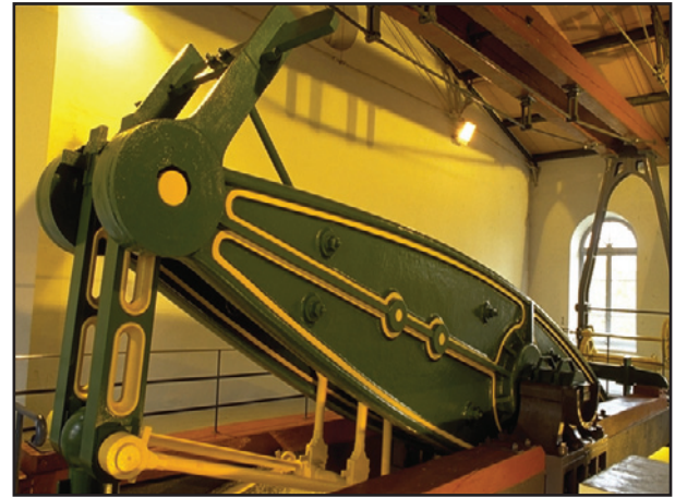
Le balancier et le parallélogramme de Watt
